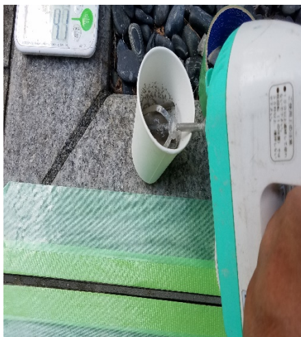
37.2gのEagle8-Qを紙コップに入れ、材料重量比24%の水を投入し、料理用のミキサーの羽を1つにし練り上げました。
