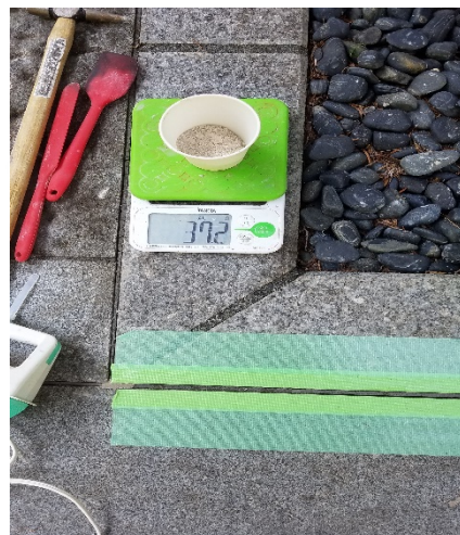
37.2gのEagle8-Qを紙コップに入れ、材料重量比24%の水を投入し、料理用のミキサーの羽を1つにし練り上げました。
