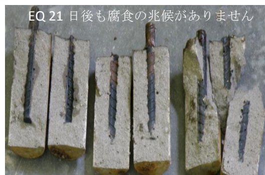
b. 21 日経過後の EAGLE 8 モルタル (腐食は見られない)
