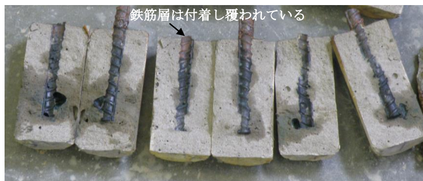
図(5) 21日経過後の EAGLE 8-Q 供試体（腐食は全く見られない）
