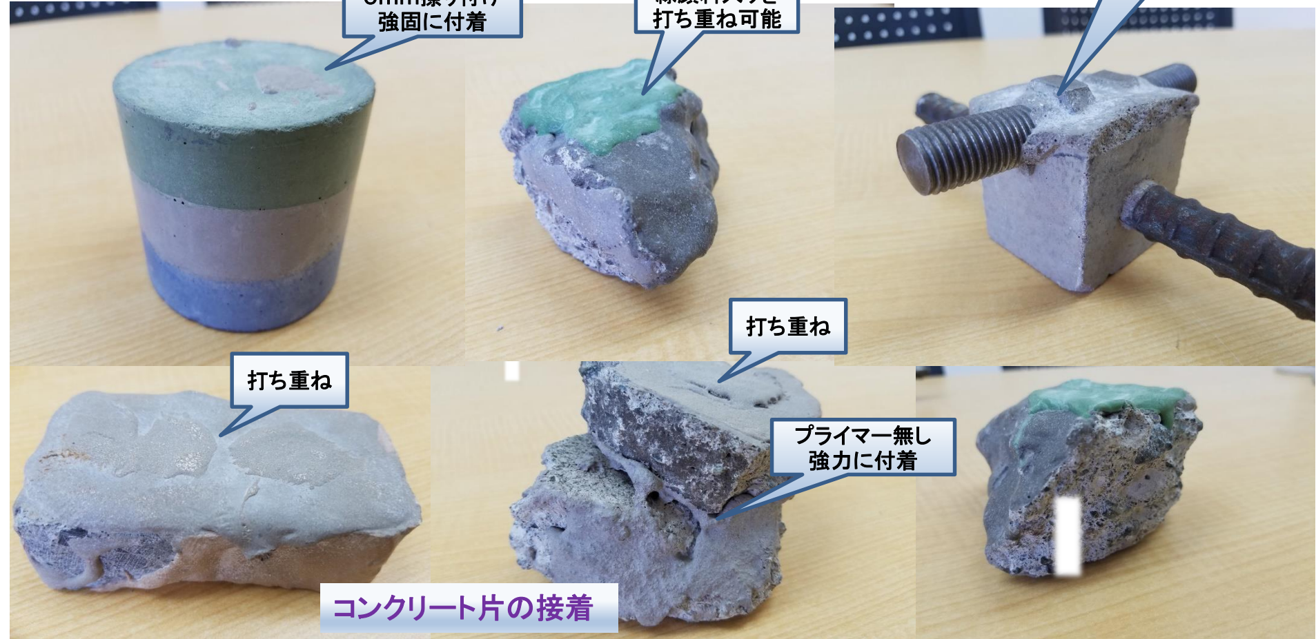
鋼材とも付着 腐食防止
