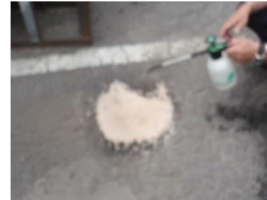
《写真③》 霧吹による、水の撒布。表面から染み出る程度に散水。
