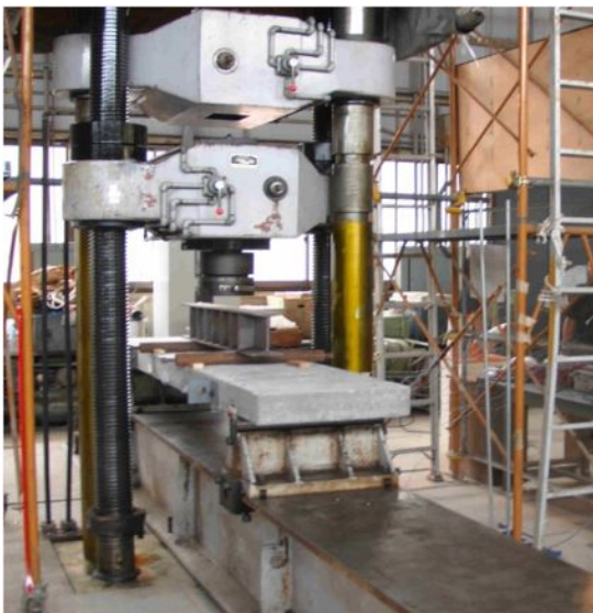
図2 荷重試験装置
